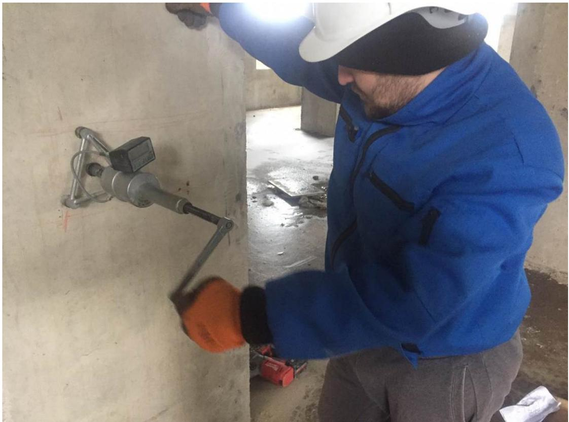
**Рис. 4.2.5. Испытание бетона монолитного железобетонного пилона в осях Д/4/7/3-7/4 методом отрыва со скалыванием прибором ПОС 50МГ-4**
