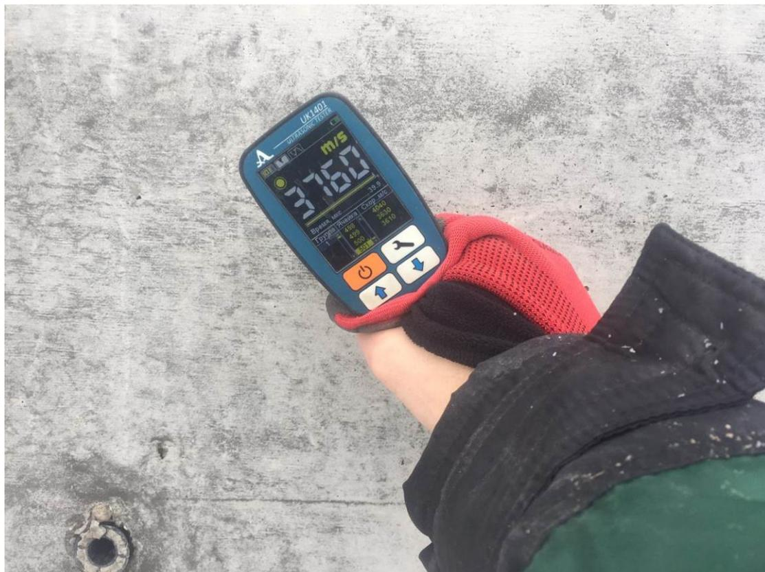
**Рис. 4.3.1. Определение прочности бетона в монолитном железобетонном пилоне ультразвуковым методом прибором UK 1401**
