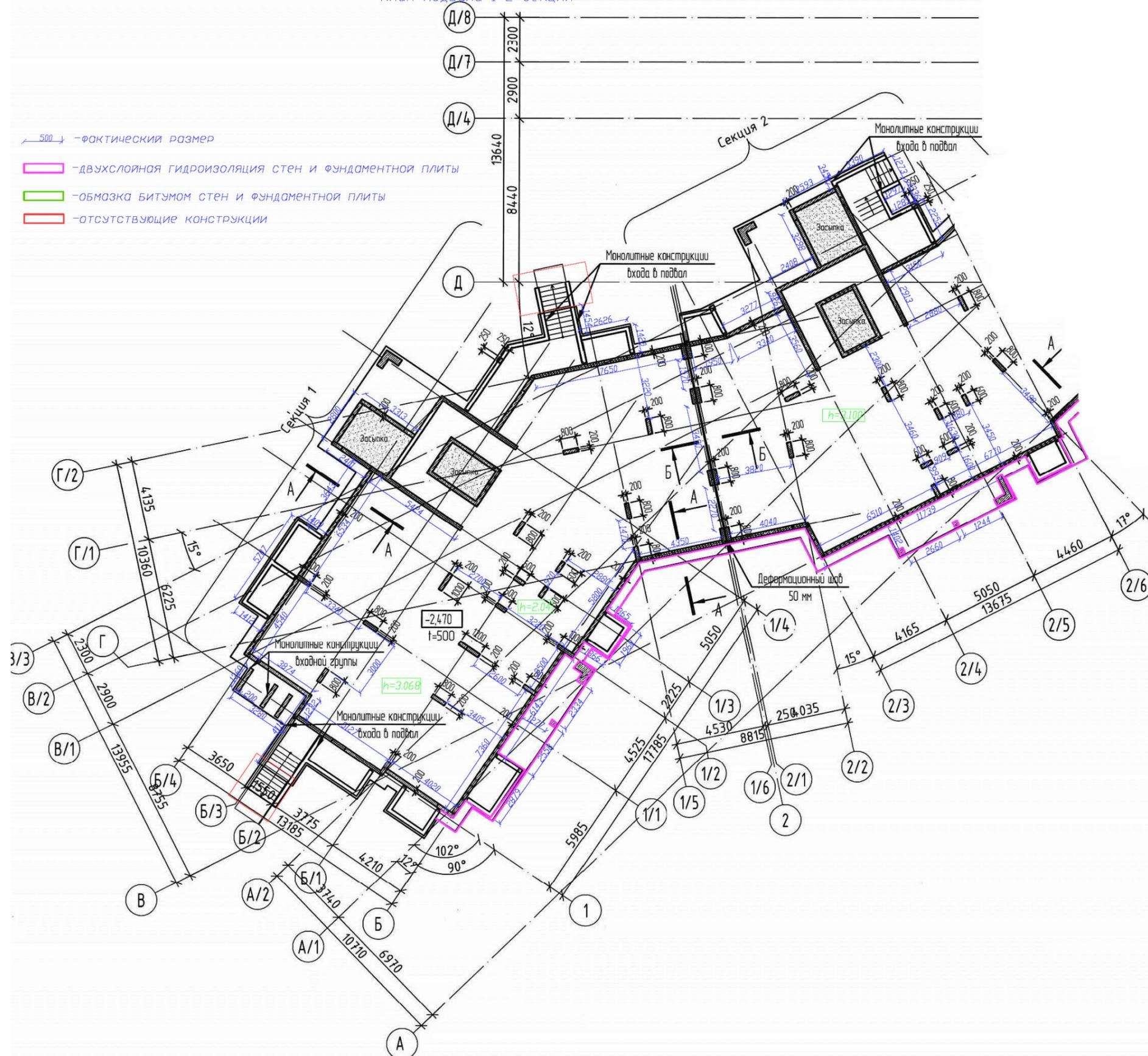
Рис. 1. Обмерочный план подвала секций №1-2
