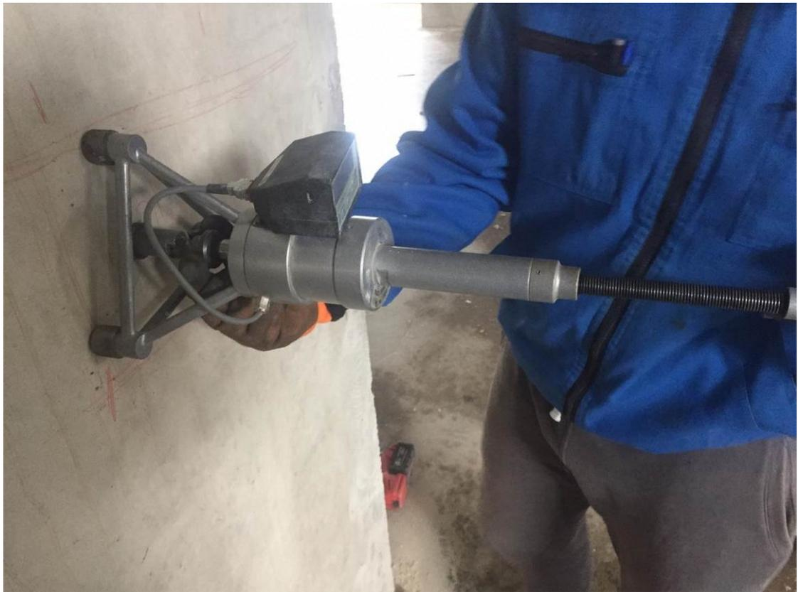
**Рис. 4.2.4. Установка прибора ПОС 50МГ-4 для проведения испытания в монолитном железобетонном пилоне в осях Д/4/7/3-7/4**
